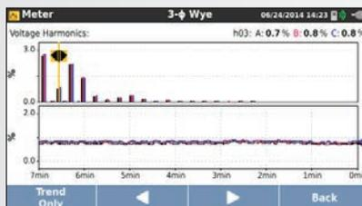
Rilevamento della fonte di distorsione di corrente e tensione che potrebbe compromettere le apparecchiature
