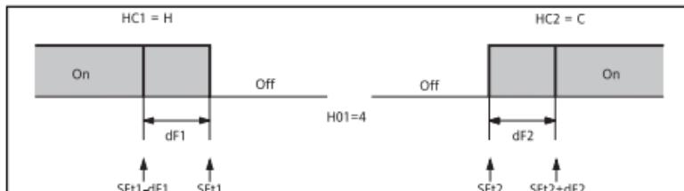
**1** Schema unabhängige ON-OFF Regelung. Die beiden Ausgänge regeln in vollständig unabhängiger Weise.
