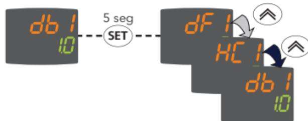
Seleccione el parámetro deseado mediante las teclas **↑** y **↓**.
