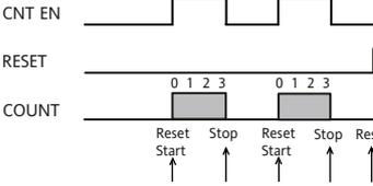
P09=3 MONOSTABILE RESET-START | STOP \* attivando l'ingresso IN\_ST\_SP e mantenendolo attivo il timer si resetta ed il conteggio viene avviato per arrestarsi sul valore raggiunto quando l'ingresso viene disattivato.
