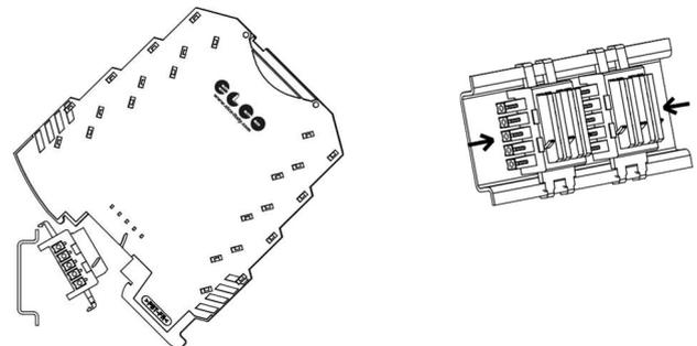
Per l'accesso alla linea Modbus ci sono gli appositi morsetti di connessione a 5poli: **TC-5PL** o **TC-5PR**.
