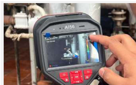
Rilevamento di perdite di gas
