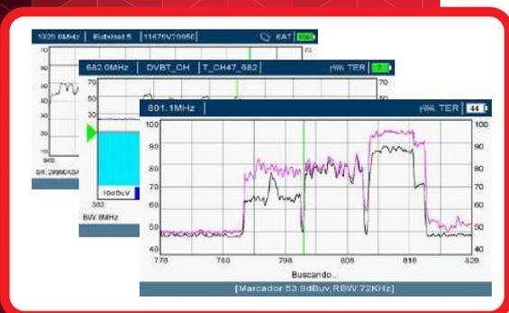
Analizzatore di spettro reale, con span e livello di riferimento regolabile. Veloce in ogni condizione, perfetto per il puntamento e la regolazione di antenne TV e SAT, grazie anche all'identificazione automatica dei segnali con lettura in tempo reale dei parametri NIT, direttamente sullo spettro. Chiaro e veloce, include funzioni avanzate come max hold e spettrogramma.
