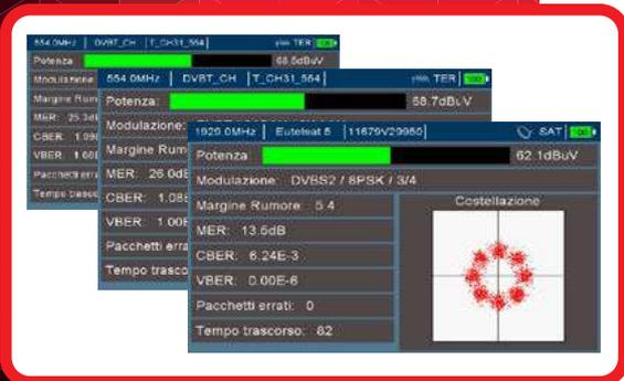
Tutte le misure in una sola schermata, facile, chiara e completa, direttamente accessibile con un solo tasto. Schermata dual-screen che consente di visualizzare assieme alle misure, un'altra funzione a scelta tra: canale tv, spettro, costellazione o parametri NIT.
