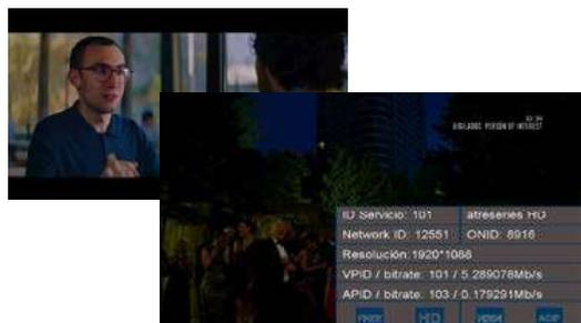
Demodulazione completa dei nuovi standard TV digitale DVBS2 e DVBT2, con misure complete, demodulazione video anche con codec H265 / HEVC 10Bit e demodulatore audio Dolby AC3, per visualizzare le immagini dei canali HD, audio incluso.
