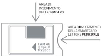
nonché delle anomalie durante la visualizzazione dei programmi televisivi 4K. Per questo motivo SmarDTV declina ogni responsabilità in caso d'impiego della CAM 4K all'interno di un TV non certificato la tivù 4K. Il modulo è dotato di un lettore principale per smartcard e di un secondo lettore di smartcard formato SIM. Per la smartcard **tivùsat 4K** va utilizzato solo il lettore principale.
