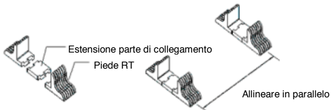
Fig. 3.2.4.2 schema di assemblaggio e posizionamento piede
