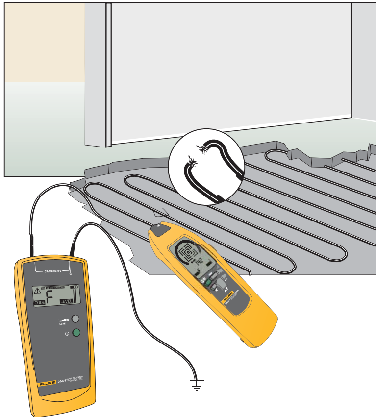
Localizzazione di guasti in impianti di riscaldamento elettrico sotto i pavimenti.
