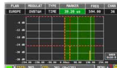
MISURE ECHI in reti SFN, con impulse response in tempo reale, l'area verde mostra l'intervallo di guardia
