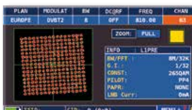
Costellazione DVB-T2 (opz.) ruotata 256 QAM mod., sulla destra i parametri di modulazione relativi e M-PLP
