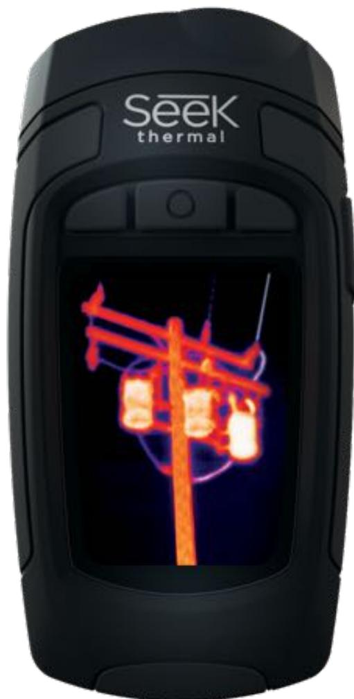
Realizzata per scopi lavorativi e per attività ricreative, la maneggevole e avanzata termocamera Seek Reveal combina analisi termografiche con una potente luce a LED di 300 lumen, in un dispositivo resistente. Con un rilevamento di temperature fra  $-40^{\circ}$  e  $330^{\circ}\text{C}$  ( $-40^{\circ}$  e  $626^{\circ}\text{F}$ ), Reveal permette di individuare e misurare specifiche fonti di calore e di dispersione termica, fino a 150 metri di distanza, al tocco di un pulsante.
