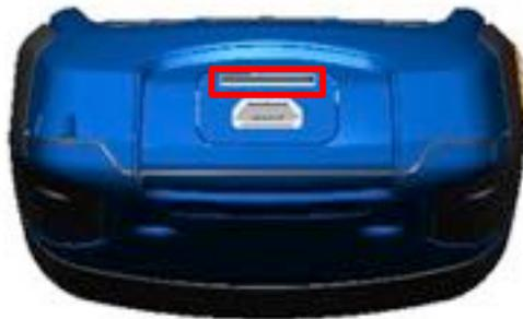
*Figura 41: Pannello posteriore di Reveal e slot della scheda micro SD evidenziato .*
