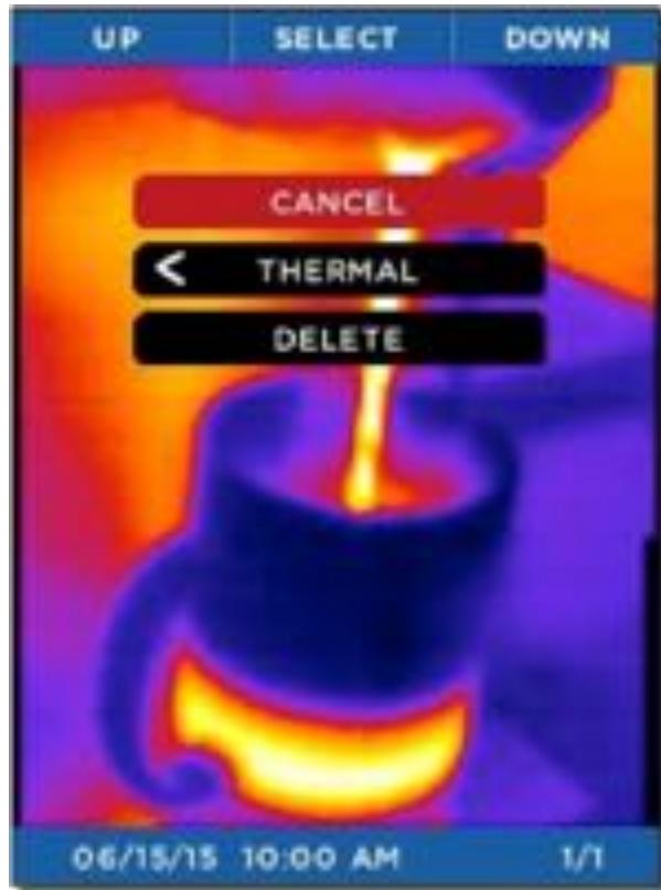
Figura 18: Schermata delle OPZIONI della raccolta.
