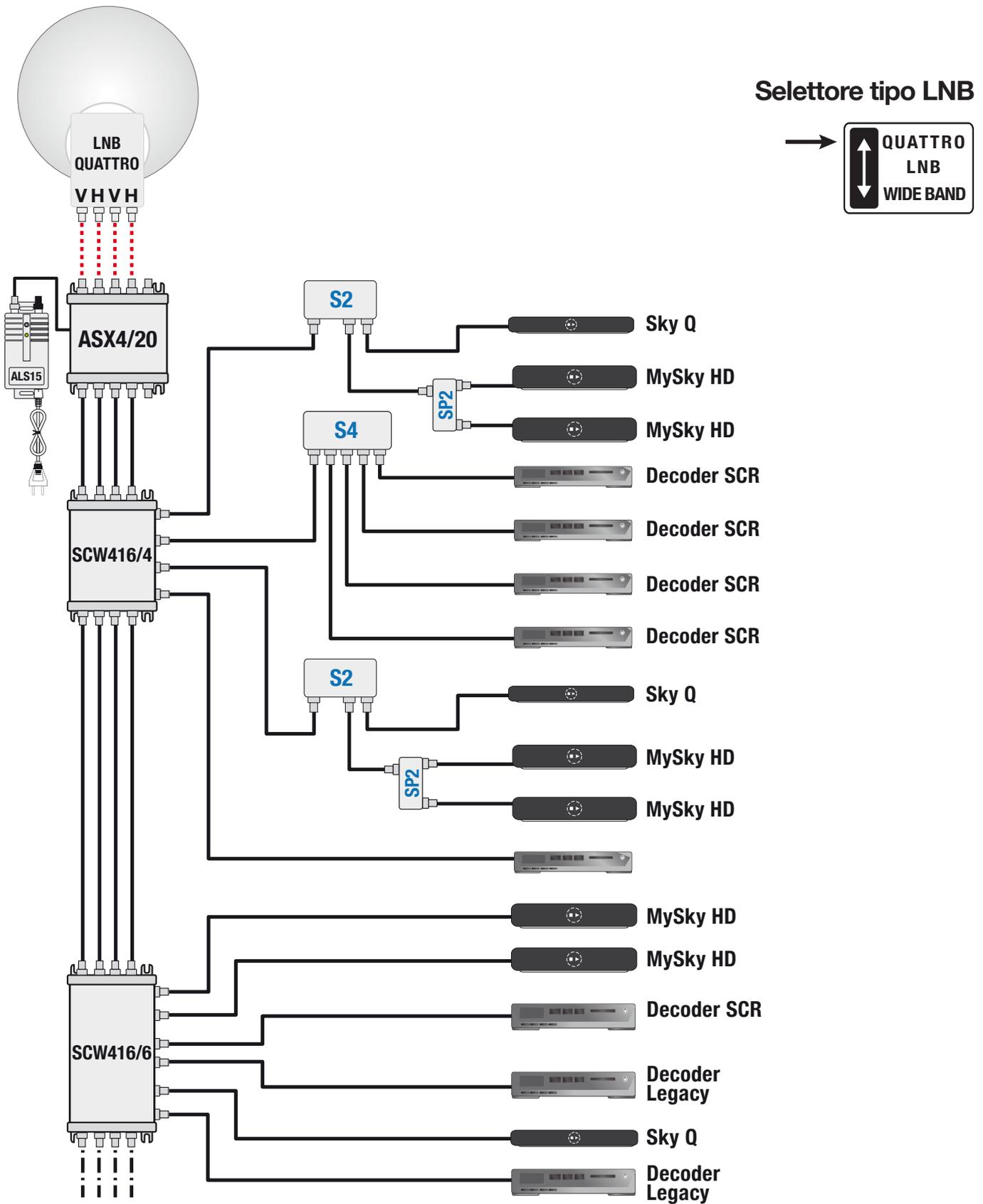
Schema di utilizzo di **SCW416/6** con l'amplificatore di testa **ASX4/20** che amplifica ed equalizza i segnali della dorsale IF-SAT e provvede all'alimentazione dell'LNB.
