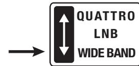
Posizionando il selettore tipo LNB presente sul multiswitch **SCW416/6** su **WIDE BAND** si abilita il funzionamento a banda estesa idoneo al funzionamento in abbinamento agli LNB Wide band **LNBWB1**.
