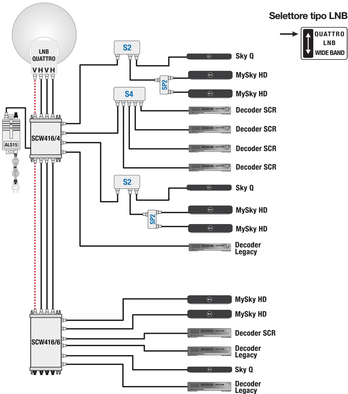
I multiswitch serie **SCW416** essendo dotati di controllo automatico del guadagno se impiegati in impianti di piccole dimensioni non richiedono l'utilizzo dell'amplificatore di testa.
