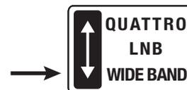
Posizionando il selettore tipo LNB presente sul multiswitch **SCW416/8** su **WIDE BAND** si abilita il funzionamento a banda estesa idoneo al funzionamento in abbinamento agli LNB Wide band **LNBWB1**.
