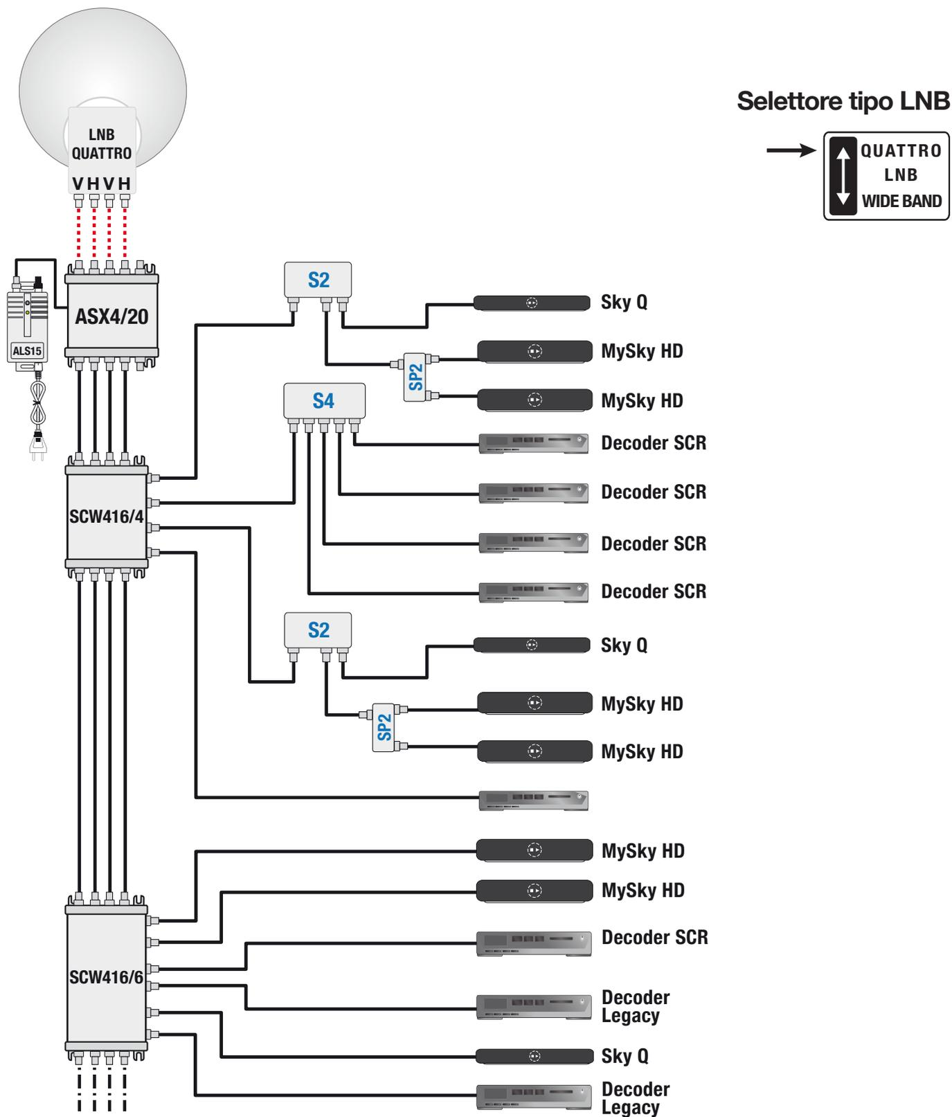
Schema di utilizzo di **SCW416** con amplificatore di testa **ASX4/20** che amplifica ed equalizza i segnali della dorsale IF-SAT e provvede all'alimentazione dell'LNB.
