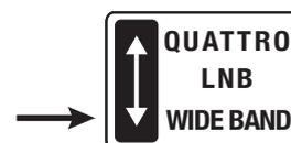
Come al punto precedente posizionando il selettore tipo LNB presente sul multiswitch **SCW416/4** su **WIDE BAND** si abilita il funzionamento a banda estesa idoneo al funzionamento in abbinamento agli LNB Wide band **LNBWB1**.
