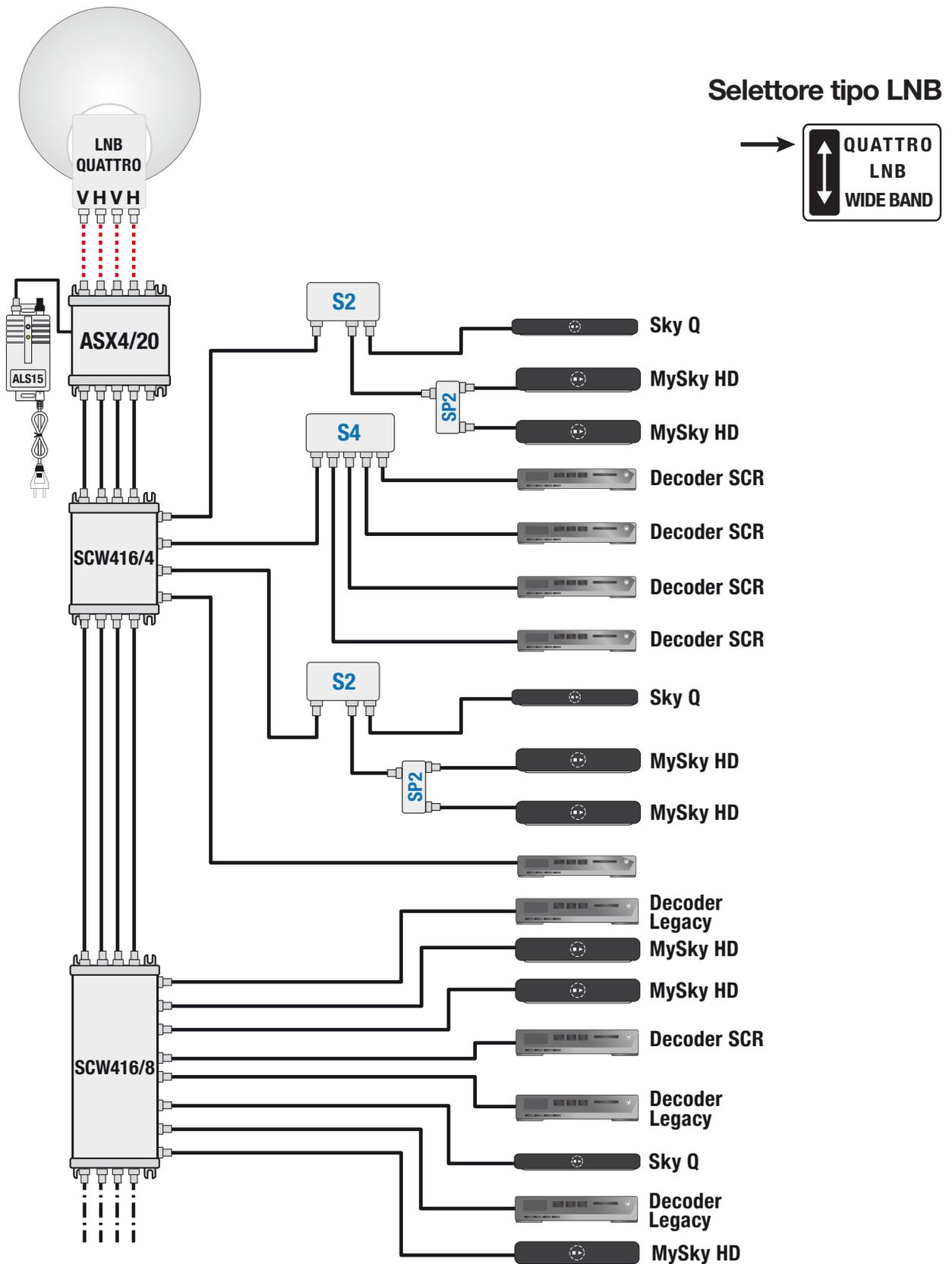
Schema di utilizzo di **SCW416/8** con l'amplificatore di testa **ASX4/20** che amplifica ed equalizza i segnali della dorsale IF-SAT e provvede all'alimentazione dell'LNB.
