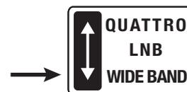
Come al punto precedente posizionando il selettore tipo LNB presente sul multiswitch **SCW416/6** su **WIDE BAND** si abilita il funzionamento a banda estesa idoneo al funzionamento in abbinamento agli LNB Wide band **LNBWB1**.
