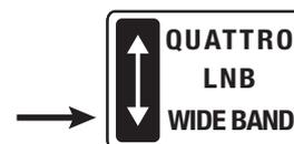
Posizionando il selettore tipo LNB presente sul multiswitch **SCW416/6** su **WIDE BAND** si abilita il funzionamento a banda estesa idoneo al funzionamento in abbinamento agli LNB Wide band **LNBWB1**.
