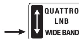
Come al punto precedente posizionando il selettore tipo LNB presente sul multiswitch **SCW416/8** su **WIDE BAND** si abilita il funzionamento a banda estesa idoneo al funzionamento in abbinamento agli LNB Wide band **LNBWB1**.
