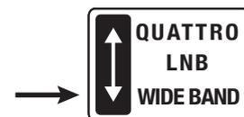
Come al punto precedente posizionando il selettore tipo LNB presente sul multiswitch **SCW416/4** su **WIDE BAND** si abilita il funzionamento a banda estesa idoneo al funzionamento in abbinamento agli LNB Wide band **LNBWB1**.
