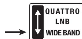
Come al punto precedente posizionando il selettore tipo LNB presente sul multiswitch **SCW416/6** su **WIDE BAND** si abilita il funzionamento a banda estesa idoneo al funzionamento in abbinamento agli LNB Wide band **LNBWB1**.
