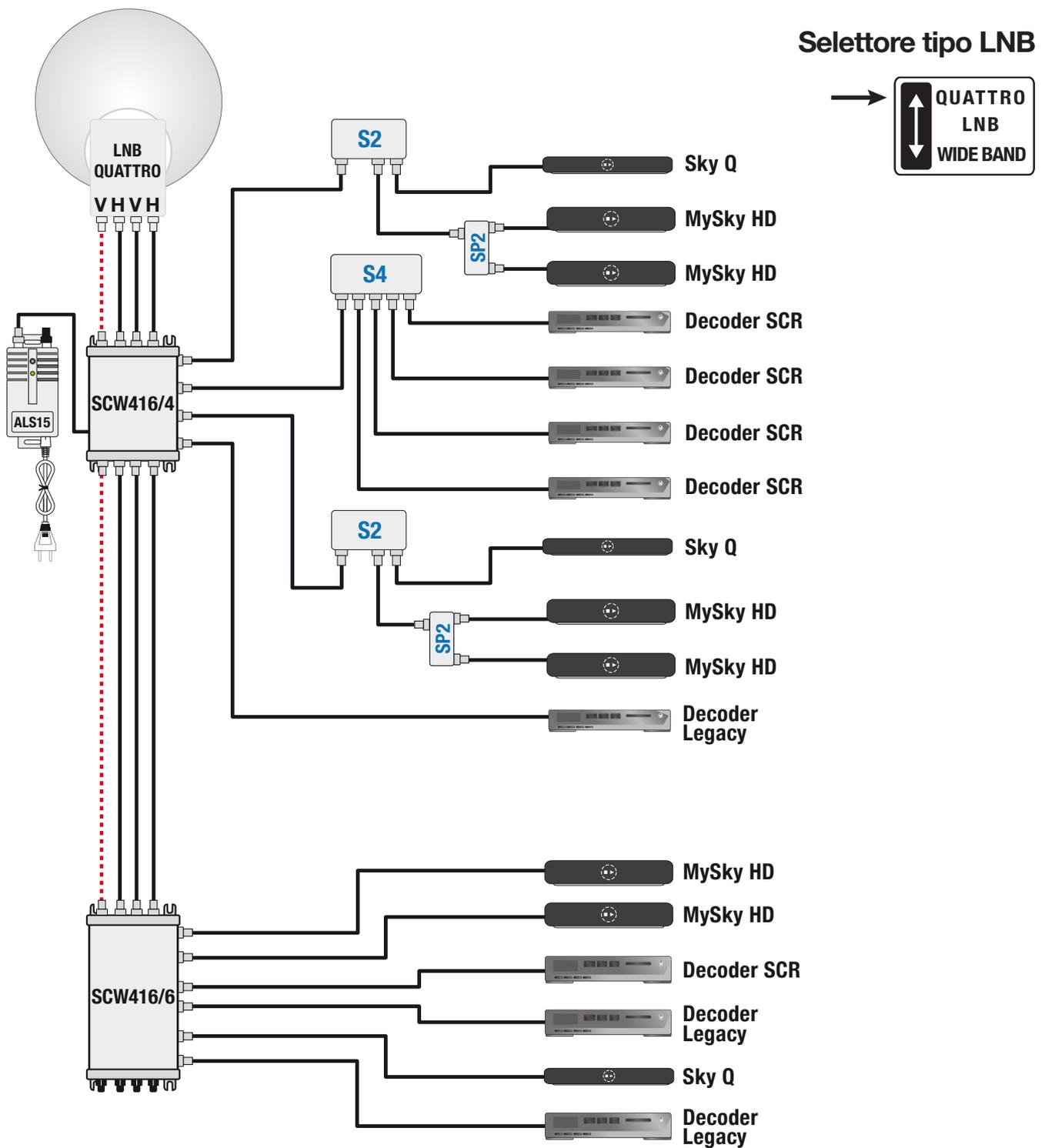
I multiswitch serie **SCW416** essendo dotati di controllo automatico del guadagno se impiegati in impianti di piccole dimensioni non richiedono l'utilizzo dell'amplificatore di testa.
