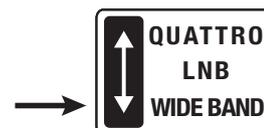
Posizionando il selettore tipo LNB presente sul multiswitch **SCW416/4** su **WIDE BAND** si abilita il funzionamento a banda estesa idoneo al funzionamento in abbinamento agli LNB Wide band **LNBWB1**.
