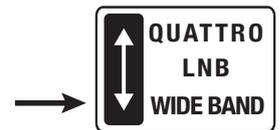
Con gli LNB Wide band sono sufficienti solo due cavi coassiali per un impianto a singolo satellite. Il multiswitch **SCD416/2** e l'LNB Wide Band **LNBWB1** sono alimentati direttamente dai decoder collegati.
