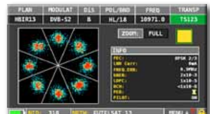
Costellazione DVB-S2 multistream mod. 8PSK, a destra i relativi parametri di modulazione e ISSY
