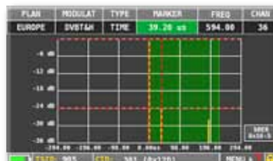
MISURA ECHI nelle Reti SFN, con Risposta all'Impulso in tempo reale, in verde l'Intervallo di Guardia
