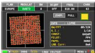
Costellazione Ruotata DVB-T2 modulazione 256 QAM, a destra i relativi parametri di modulazione e M-PLP
