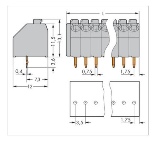
Anteprima stampa: Morsettiera per circuito stampato per 1 conduttore; 1 pin a saldare/polo frontale; 8 poli; Passo 3,5 mm / 0,138 poll; con pulsante; con porta per test per spina di test, O 1,3 mm - Cod. Art.: 250-108
