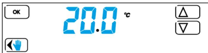
Impostata la temperatura e confermato con OK il cronotermostato avvia la funzione manuale temporizzato (il display sul lato a destra mostra una sequenza circolare)
