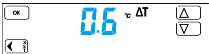
Il differenziale termico serve per regolare il termostato a seconda della tipologia di impianto da comandare.
