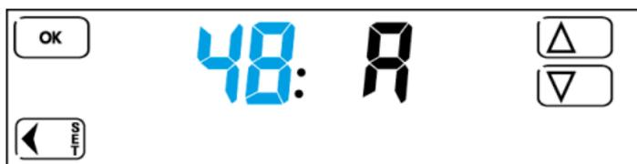
Impostando con i tasti **▲** o **▼** il valore 48 (48 ore = 2 giorni) e confermando con **OK**, il termostato, ogni 2 giorni, chiuderà il contatto del relè per 30 secondi. Abilitata la funzione nel menù, la partenza del conteggio inizierà dopo l'ultimo spegnimento del relè.
