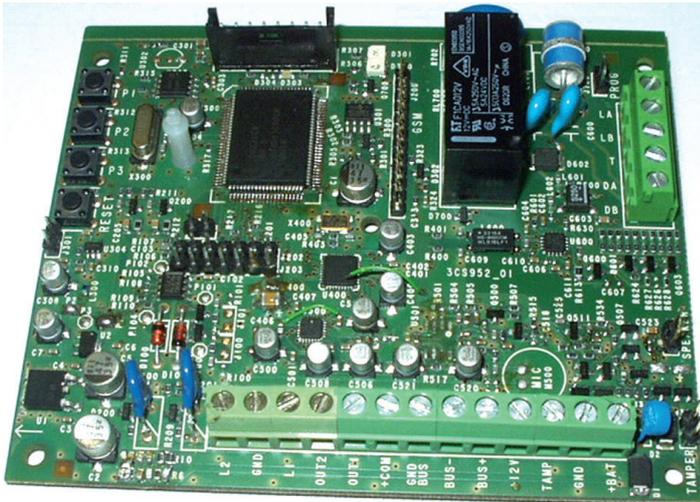
Il **CT-BUS** è un combinatore telefonico digitale, con sintesi vocale integrata, per la trasmissione su linea telefonica PSTN di informazioni relative agli allarmi e allo stato dell'impianto.
