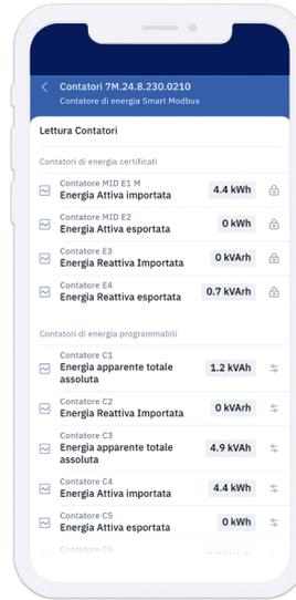
Anche in assenza di tensione saranno visualizzati tutti i contatori, non solo quelli MID
