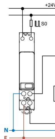
**Contatore di energia monofase bidirezionale con tecnologia NFC, certificato MID e display LCD**
