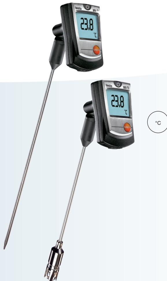
testo 905-T1 è uno dei più veloci termometri a penetrazione con un ampio campo di misura da -50 a +350 °C, nel breve periodo anche fino a +500 °C (da 1 a 2 minuti). Lo strumento di misura è dotato di sensore industriale professionale (termocoppia Tipo K). Presenta un livello di precisione eccellente soprattutto nel campo di misura superiore.
