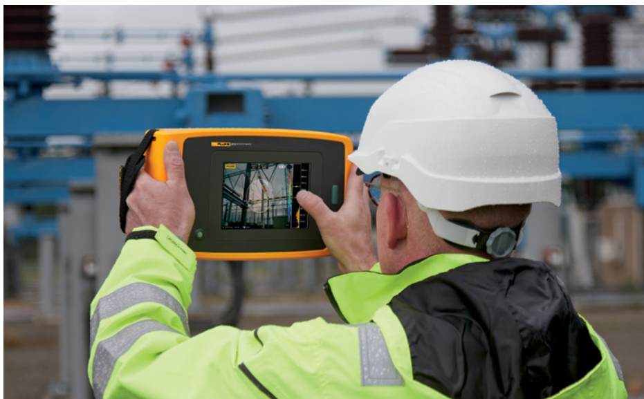
Immagine acquisita dalla telecamera acustica di precisione ii910 mentre rileva una scarica parziale in un'applicazione ad alta tensione.
