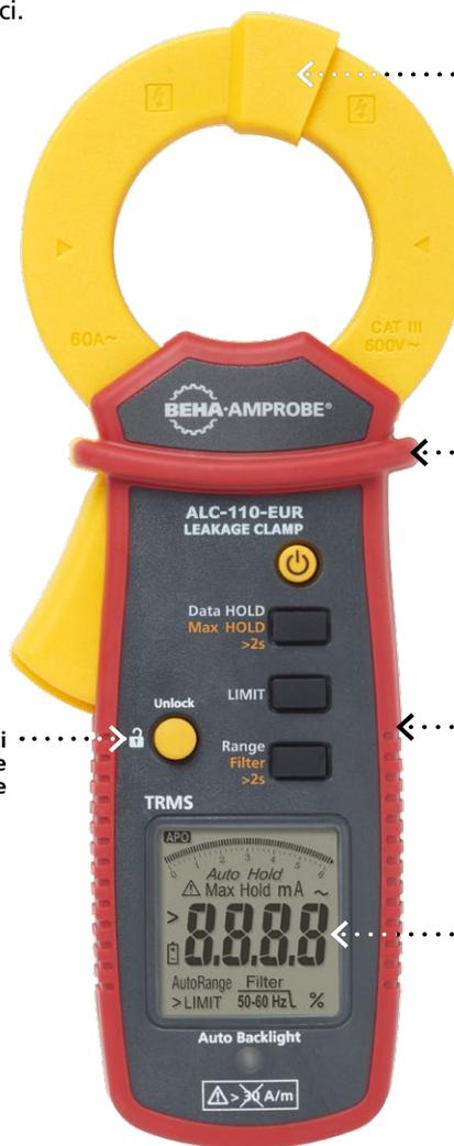
• **Blocco meccanico; pinza serrata per una maggiore precisione,** permette di evitare problemi dai cavi misurati e dai campi magnetici
