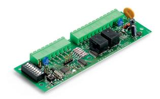
Il modulo **M8IBUS** è una scheda a 8 uscite che permette l'espansione delle centrali Defender 64, collegandosi direttamente al bus di centrale. Il modulo è installabile direttamente in centrale o all'interno dei contenitori MODBOX e CE64BOX.
