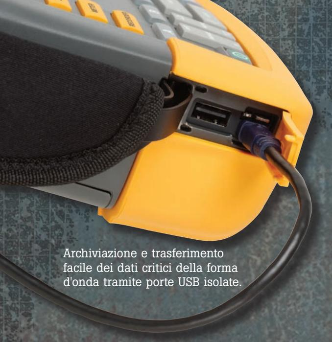
Archiviazione e trasferimento facile dei dati critici della forma d'onda tramite porte USB isolate.
