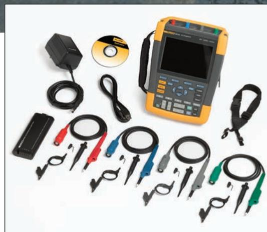
Gli strumenti Fluke serie 190 II includono una serie di sonde di tensione (2 o 4 a seconda del modello), cordino, cavo USB con miniconnettore B, batteria a doppia capacità Li-ion BP291, caricabatterie/adattatore di potenza BC190, demo FlukeView e manuali dell'utente su CD.
