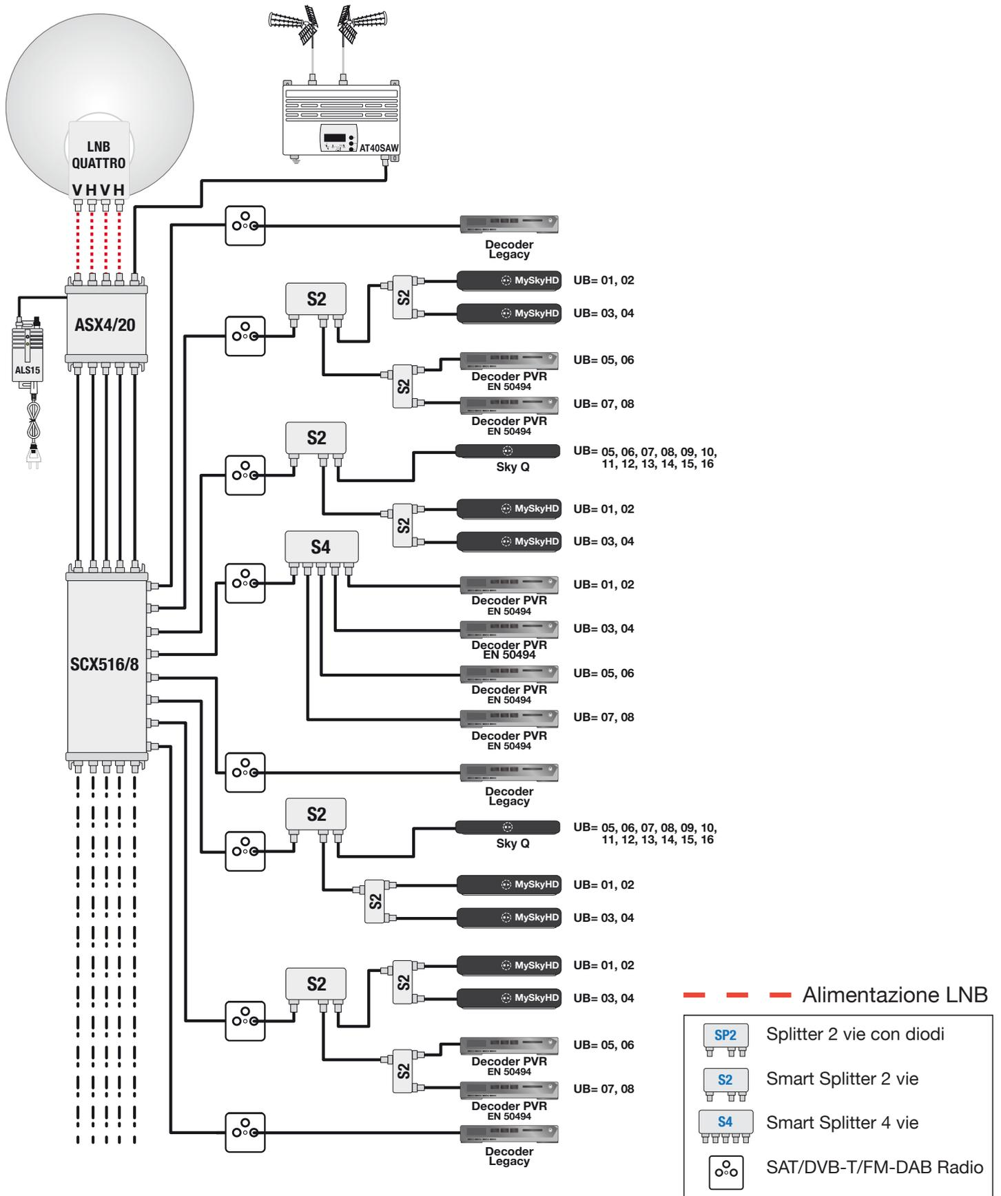
Schema di utilizzo di **SCX516/8** con amplificatore di testa **ASX4/20** che amplifica equalizzando i segnali della dorsale IF-SAT e provvede all'alimentazione dell'LNB.
