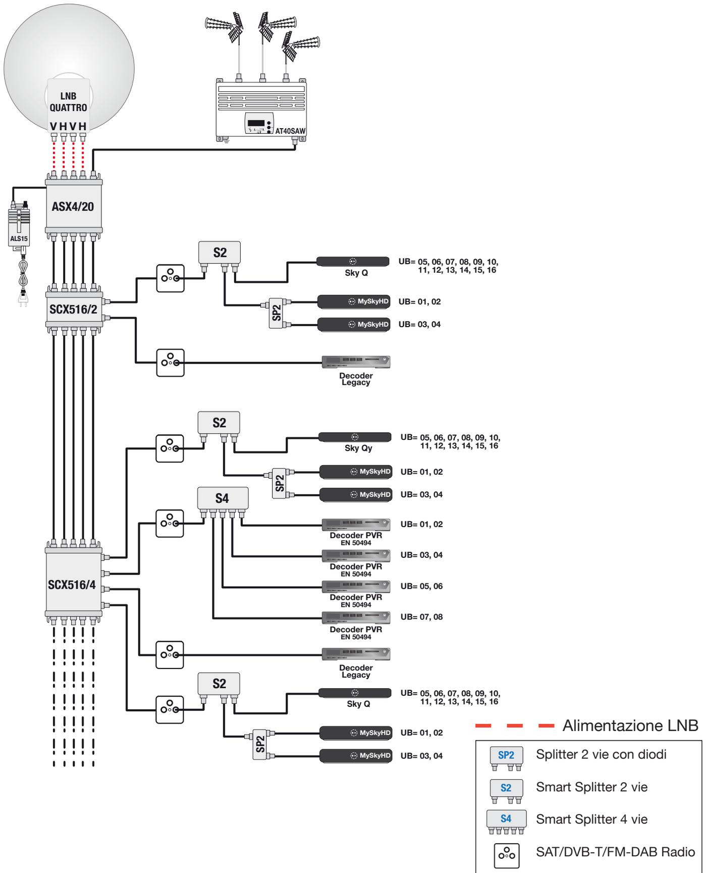
Schema di utilizzo di **SCX516/2** con amplificatore di testa **ASX4/20** che amplifica equalizzando i segnali della dorsale IF-SAT e provvede all'alimentazione dell'LNB.
