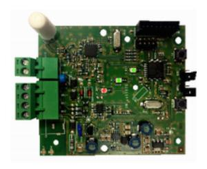
MOD-WL16 consente di realizzare sistemi misti collegando fino a 16 rilevatori, 16 telecomandi e 4 sirene del sistema WIRELESS Fracarro ad una centrale Defender filare tramite connessione BUS.
