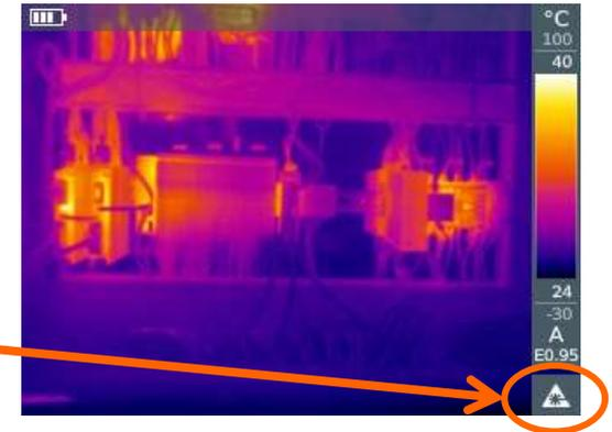
Muovere il joystick a destra per selezionare il puntatore laser nel soft key menu. Accendere il puntatore laser premendo il tasto softkey una volta. Se il tasto softkey era già stato premuto, il puntatore laser verrà spento.
