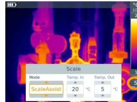
Scala Assistita: Inserire la temperature interna ed esterna. La scala sarà settata automaticamente basandosi su questi dati di temperatura. Questo permette di evitare la scelta di una scala sbagliata nell'applicazione dell'involucro edilizio e tiene conto delle differenti condizioni ambientali.
