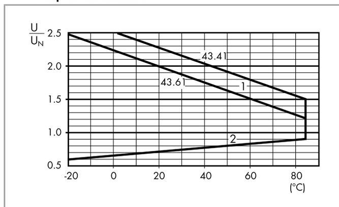
1 - Max tensione bobina ammissibile.
