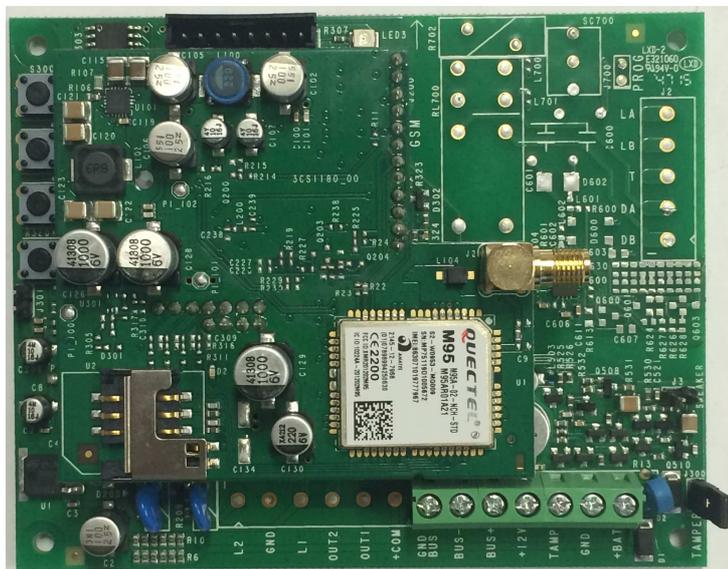
Il **CT-BUS GSM** è un combinatore telefonico digitale, con sintesi vocale integrata, per la trasmissione su linea telefonica GSM di informazioni relative agli allarmi e allo stato dell'impianto.
