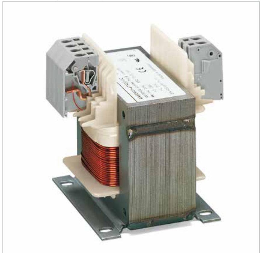
Nach dem Kontaktieren der Spulendrähte (bei Schneidklemmanschluss nur 1 Draht pro Kontakt! - Schlaufen möglich) - Aufsetzen des Klemmenblocks auf den Spulenkörper (Klemmen und Abschlussplatte vorher zusammenrasten)
