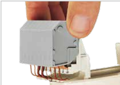
Aufsetzen des Klemmenblocks auf den Adapter (Klemmen und Abschlussplatte vorher zusammenrasten)
