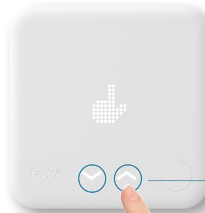
Per disattivare il controllo manuale e tornare alla programmazione intelligente premi il pulsante e passa con le frecce dal simbolo del controllo manuale a quello che indica l'attuale modalità nella programmazione intelligente.
