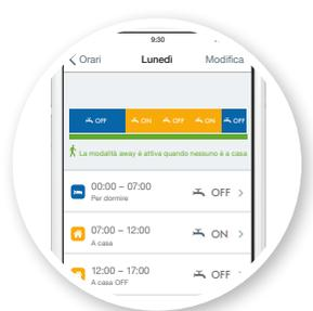
La produzione d'acqua calda è regolata da una propria programmazione intelligente. Per alcuni sistemi digitali è possibile impostarne anche la temperatura.
