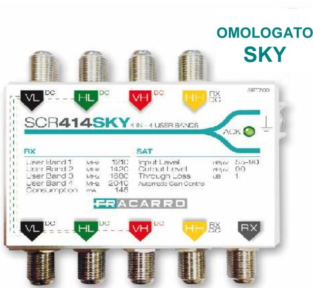
Nuovo multiswitch in cascata con tecnologia SCR 4 ingressi, 4 uscite passanti, 1 uscita utente con 4 frequenze. Il prodotto **consente di poter collegare su un unico cavo fino a 4 decoder SKY** che supportano la tecnologia SCR.
