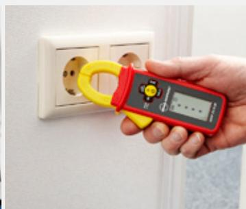
**La funzione di rilevamento tensione senza contatto (NCV)** verifica la presenza di tensione.
