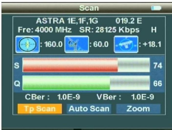
**2.1.1.12** Settare i parametri e premere il tasto “OK” per entrare nel Sottomenu, e poi regolare la parabola in base ai parametri d’interfaccia.
