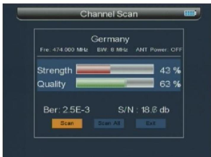
Scansiona tutti i canali della frequenza corrente, immagazzina automaticamente i canali scansionati e poi ritorna al menu precedente.
