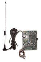
Il combinatore telefonico è in grado di trasmettere 3 diversi messaggi pre-registrati attraverso la linea telefonica GSM. E' inoltre in grado di mandare 10 diversi messaggi SMS pre-impostati attraverso la linea GSM.
