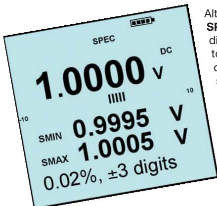
Altra innovazione: la funzione **SPEC** permette di visualizzare direttamente sullo schermo la tolleranza della misura in corso senza che sia necessario cercarla e calcolarla.
