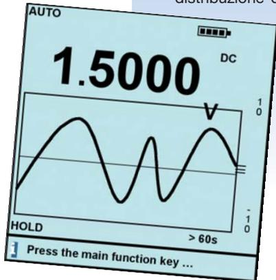
Molto semplicemente la finestra di registrazione grafica fornisce la 3a dimensione con l'evoluzione della misura nel tempo, garantendo un riscontro.
