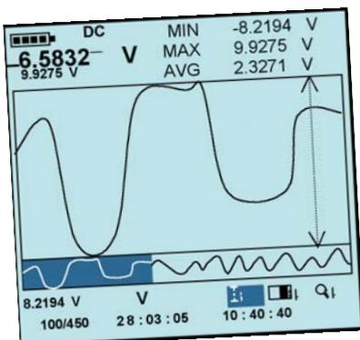
Se questo non bastasse, il tasto MEM registra addirittura 6500 misure orodate con cadenze comprese fra 1s e 24 ore, permettendo di analizzarle graficamente sullo strumento, anche più di una registrazione (fino a 4) simultaneamente.
