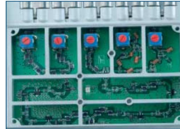
All'interno il circuito stampato è stato separato da celle in pressofusione fra ogni singola banda di frequenza.
